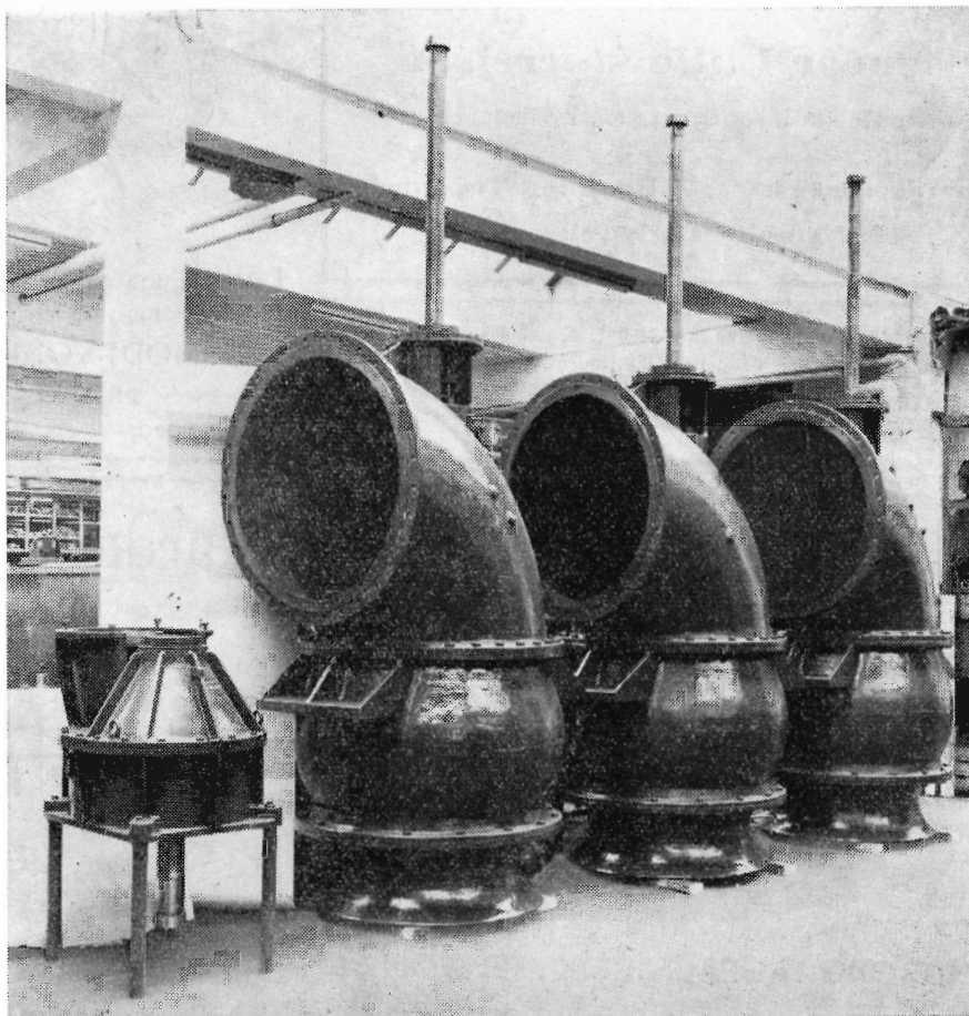
3 stk. 1000 mm propellerpumper hver med en kapacitet af 1600 liter/sekund
