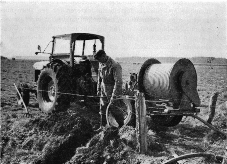
Højtryksmaskine til rensning af drænledninger.
