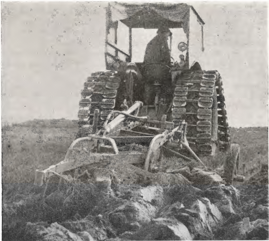
Pløjning på Københavnerheden i foråret 1959 med svær dobbeltplov, pløjedybde ca. 30 cm, samlet furebredde ca. 110 cm.
