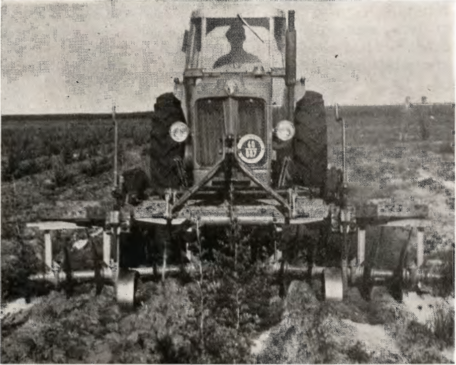
Knivharve foran traktor til rensning mellem rækker af lærk ved Gedhus. Det er første gang en sådan rensningsmetode er taget i anvendelse.
