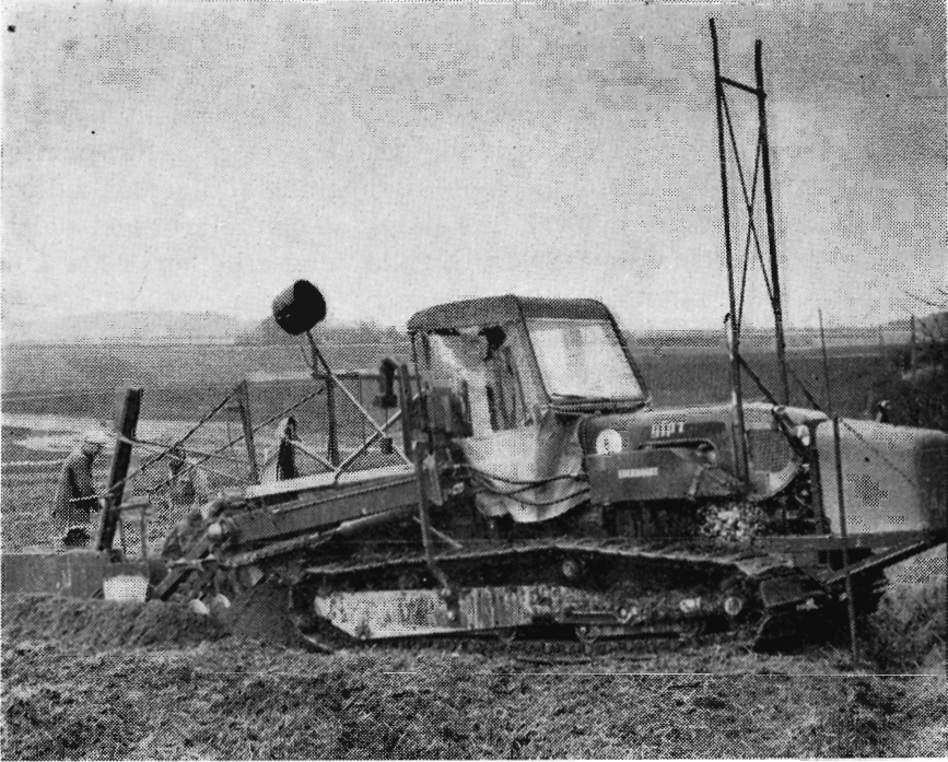
I marts købte Hedeselskabet denne robuste tyske drænggravemaskine, der kan lægge både tegl- og plastrør.
