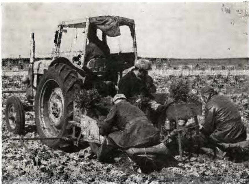
Plantemaskinen arbejder i Gedhus plantage. Den planter 20—25.000 planter pr. 8 timers arbejdsdag. Planterne kan blandes efter ønske.
