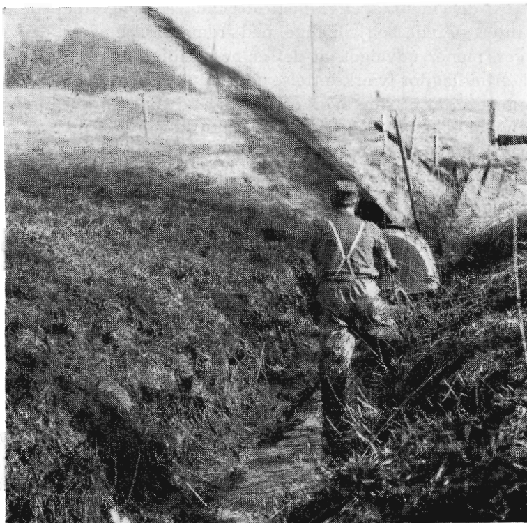
Grøfterenserens mindste model i virksomhed i en hidtil næsten lukket grøft. I baggrunden de to planker som aggregatet trækker sig op på for enden af grøften.
