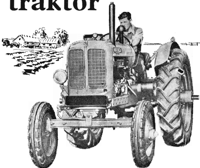
Radrensning. Alle modeller har indstillelig sporvidde med glidende bagaksel.
