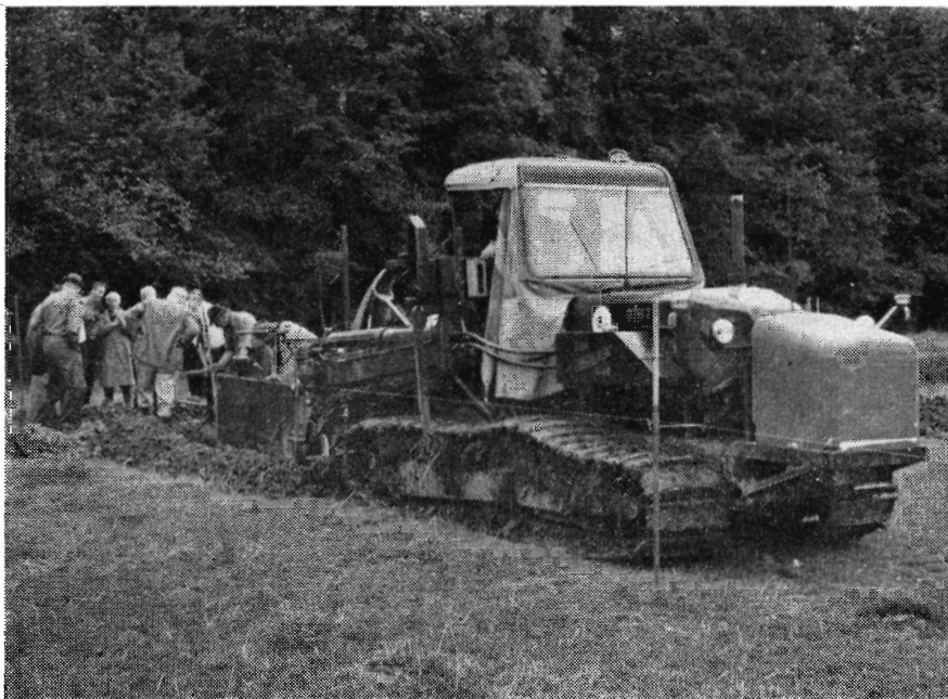
Den 8,5 t tunge drængravemaskine er udstyret med så brede bælter, at den også kan arbejde på blød mosebund.
