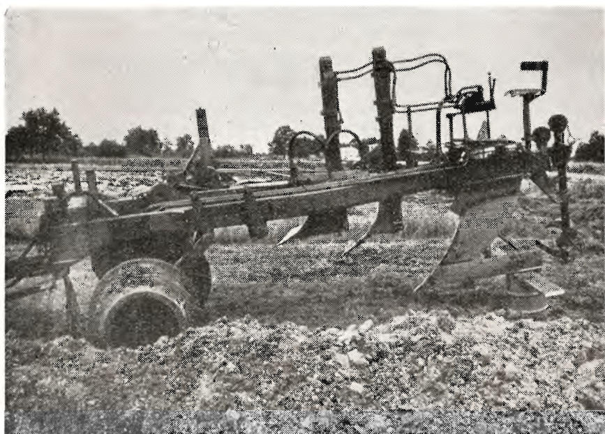
To forskellige typer af hollandske kæmpepløve. De tre skær er anbragt i forskelligt og indstilleligt forhold, således at man kan blande jordlagene efter behov under pløjningen.
