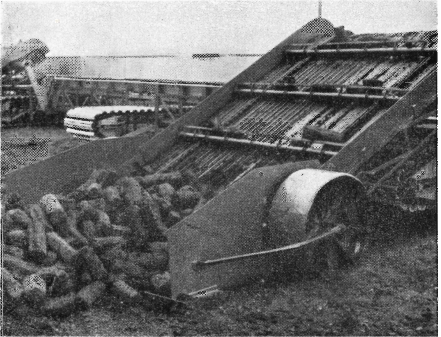
Maskine til indsamling af de færdige tørv til sporet, der er placeret for enden af udlæggebanen. Maskinen, der er selvtransportabel, er 54 m bred; den er af tysk oprindelse.
