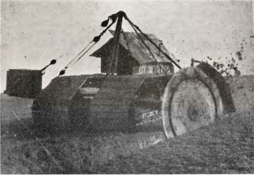
Grøftegravemaskine, som anvendes ved afvandingen af fræsetørvearealerne.
