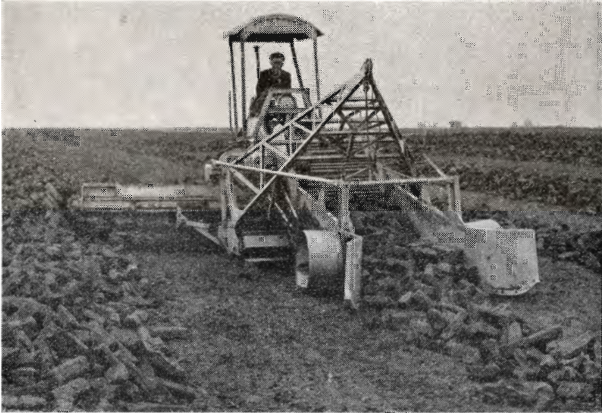
Maskine til vending og samling af tørvene i små revler.
