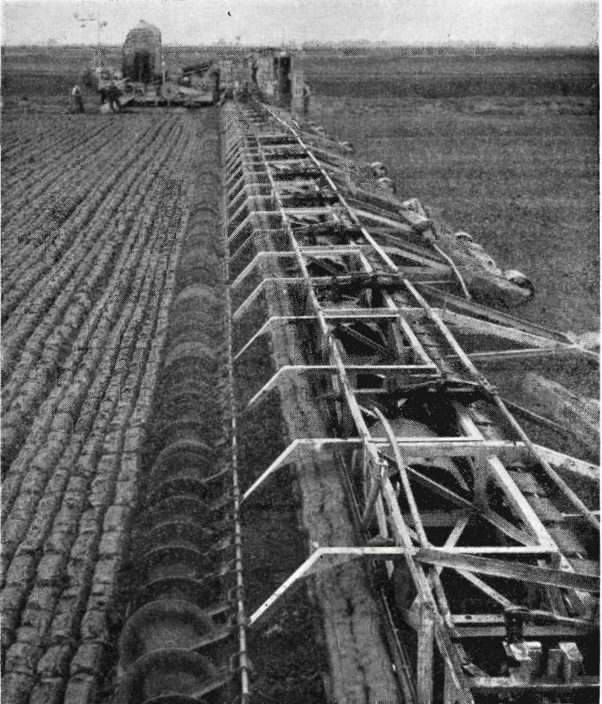
Stor tørvemaskine med automatisk udlægning af tørvene.
