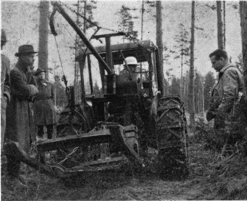
Traktoren Buster med slæbeanordning og let kranarm med wire og griberkrog. Det er en 40 HK dieselmotor med startmotor på 4 HK og 42 cm frigangshøjde og ramme for anbringelse af forskellige redskaber.
