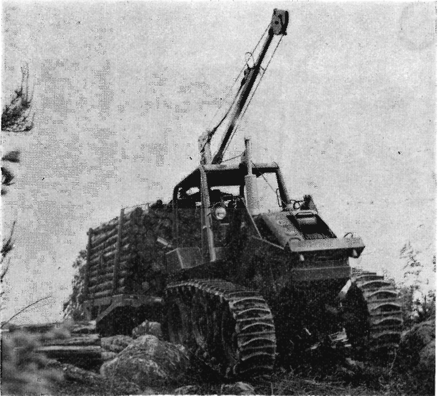
Bamse-traktoren med fjernstyret, hydraulisk kranarm, forspændt en lastet påhængsvogn på vej gennem et meget uvejsomt og vanskeligt terræn. Traktoren har 48,5 cm fri højde over jorden og kan udstyres med særlig grave-maskine-apparatur fra Hymas-Fabriken eller med skovvild.
