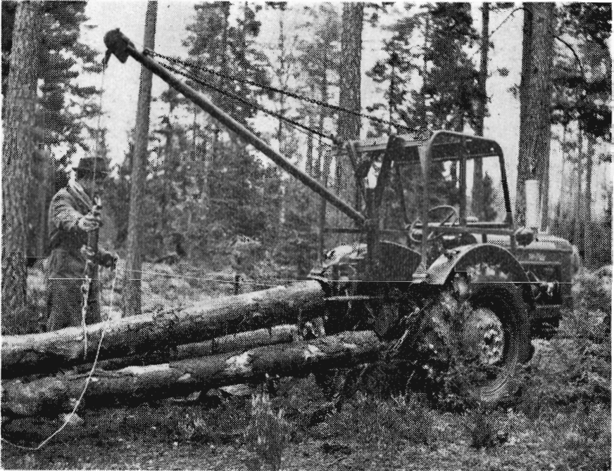
Transport af stammer på slædeaggregat efter traktor. Kranarmen dirigeres med snoretræk bagved traktoren, med kabel eller fjernstyring. Derved er opnået, at traktoren er eenmands-betjent.
