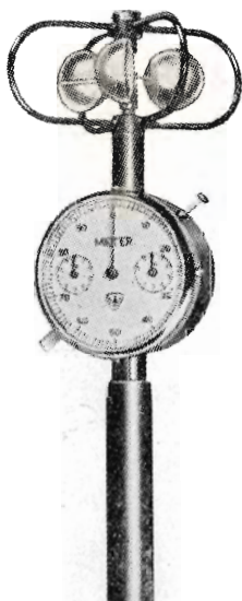
Fig. 7. Skålanemometer. Instrumentets totale højde er 22 cm.
