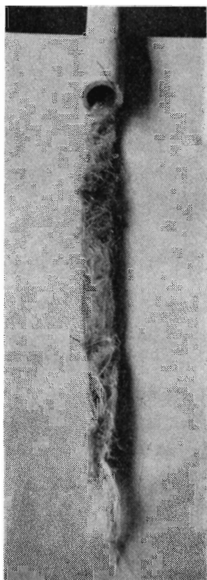
Fig. 3. Pilerødder fra dræn pakket med gasrensemasse. Røret er optaget et år efter arealets tilplantning.
