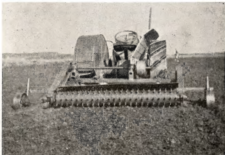
Overalt i landet eksperimenteres der med rationalisering af fræsetørvfremstillingen. Billedet viser et forsøg med en hurtiggående pigbesat fræsetromle, der er direkte tilkoblet en alm. landbrugstraktor.
