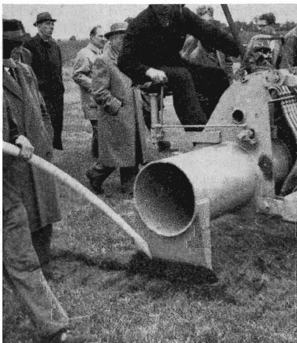
Fig. 4. Under fremkøringen trækkes en flexibel plastledning ned i turbulatorgangen.
