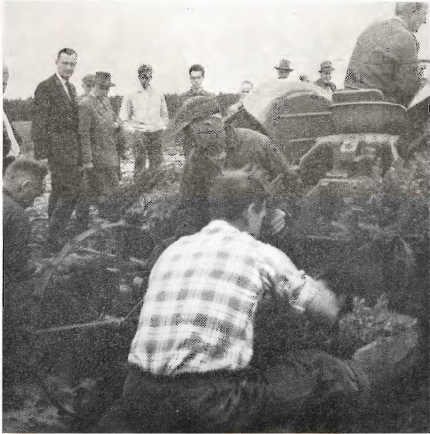
Plantemaskinen arbejder i Gedhus plantage. Den planter 20—25.000 planter pr. 8-timers arbejdsdag. Manden i midten fordele planterne.
