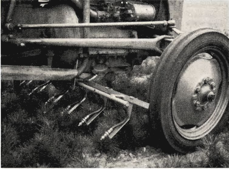
Fig. 2. Ukrudtssprøjtning. Sprøjteagregat til række kulturer. Dyserne er anbragt mellem rækkerne, så planterne ikke rammes direkte.
