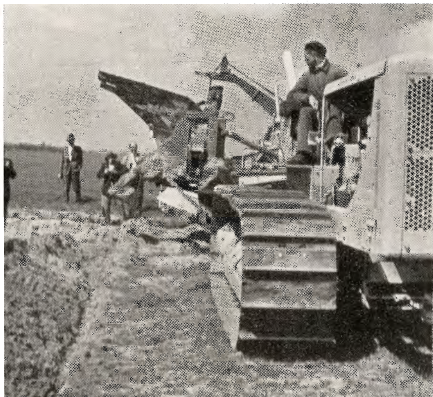
Fig. 3. Kæmpeplov, der kan pløje 175 cm dybt. (Nordøstpolder).
