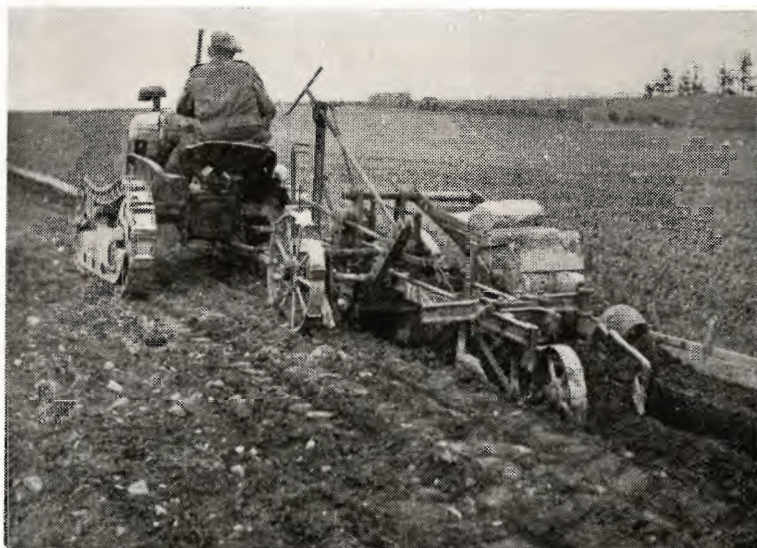
Fig. 1. The Leedmore-plough, der på een gang kommer jord på planterødderne, trykker den til, pløjer en ny fure ind til dem og afsætter en skarp kant til næste priklerække.
