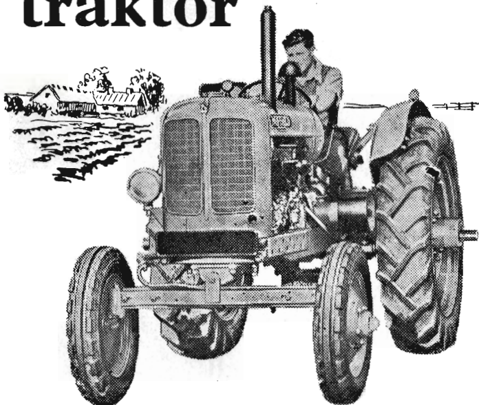
Radrensning. Alle modeller har indstillelig sporvidde med glidende bagaksel.
