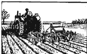
Radrensning. Alle modeller har indstillelig sporvidde med glidende bagaksel.
