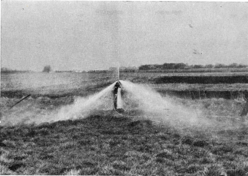
Fig. 2. Under stort tryk presses vandet ud gennem strålespidsens udboringer.
