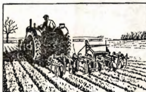
Radrensning. Alle modeller har indstillelig sporvidde.
