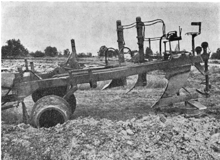
En af de hollandske dybpløjningsplove, der blev demonstreret i Holland. Ploven anvendes i lagdelt jord, men jord, hvor der ikke findes større sten.
