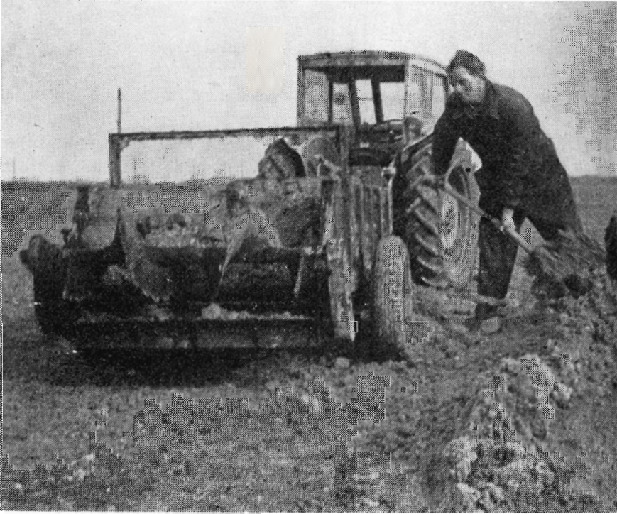
Nærbillede af mergelsprederapparatet på traktortrukken vogn, bygget af H. Sønderby, Tarm. Mergelen læsses.
