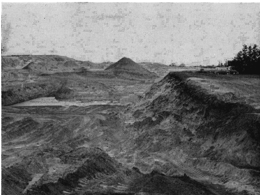
I Søby forberedes åbningen af et nyt brunkulsleje. Den lille vandsamling midt i billedet viser, hvor brunkulslaget er nået i 14 meters dybde. Det nye leje ligger i fortsættelse af allerede afgravede områder, fot. maj 1963.
