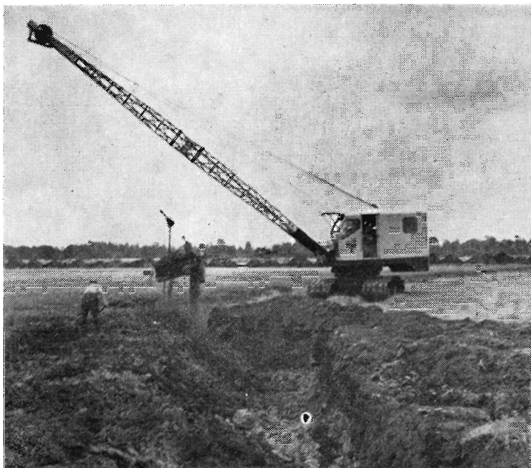
Fig. 2. Dyb jordbehandling med gravemaskine. Denne fremgangsmåde benyttes på mindre arealer, hvor det af en eller anden grund er uhen-sigtsmæssig at benytte dybdeplø. Prisen for arbejdet angives at være 25.000—30.000 kr. pr. ha.
