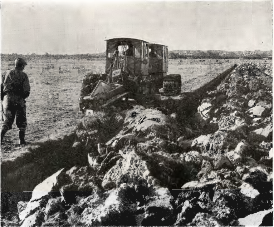
Fig. 8. Hedeselskabets store dybdeplow i virksomhed på de tørlagte enge. I forbindelse med afvandringsarbejdet er der af Hedeselskabet foretaget en omhyggelig undersøgelse af jordbunden med henblik på opdyrkning og kultivering. Resultatet af undersøgelseerne blev blandt andet, at dybdepløjning måtte anbefales på en del af arealerne, og her henter dybdeploven megen værdifuld klæg op til jordoverfladen.
