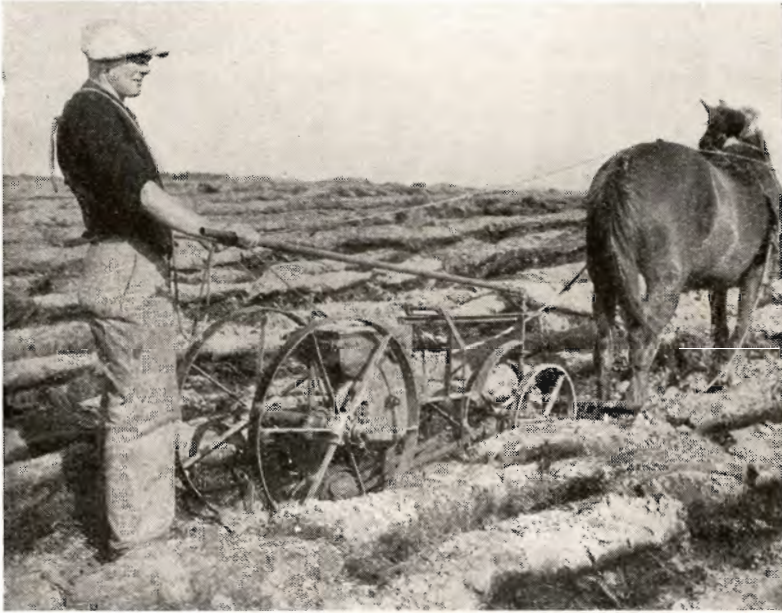
Saamaskine til Saaning af Skovfrø. Maskinen lægger eet Frø ad Gangen.
