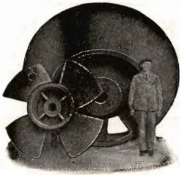
Dele til Pumpe for 4000 l/Sek.
