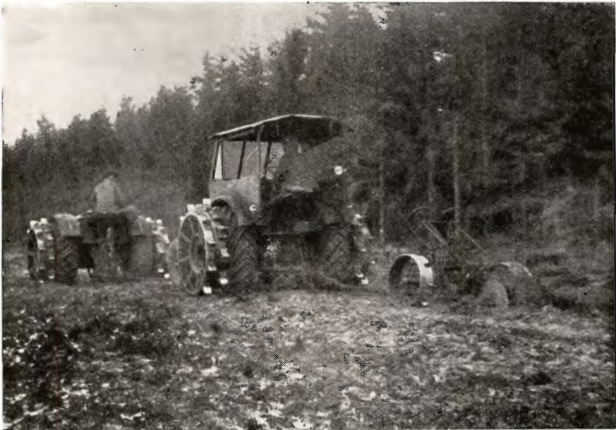
Maskincentralen dybpløjer hede til plantning på et areal under statsskovene. Fot. 1950.
