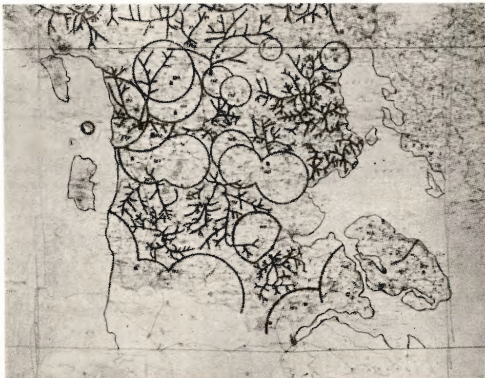
Oversigtskort, der viser Mergelselskaberne i Sønderjylland, oprettet i Tiden 1920—45. Cirkelbuerne markerer et Selskab, hvor der er udkørt pr. Lastbil, og de øvrige Spornet viser Udkørsel pr. Bane efter flyttelige Spor.
