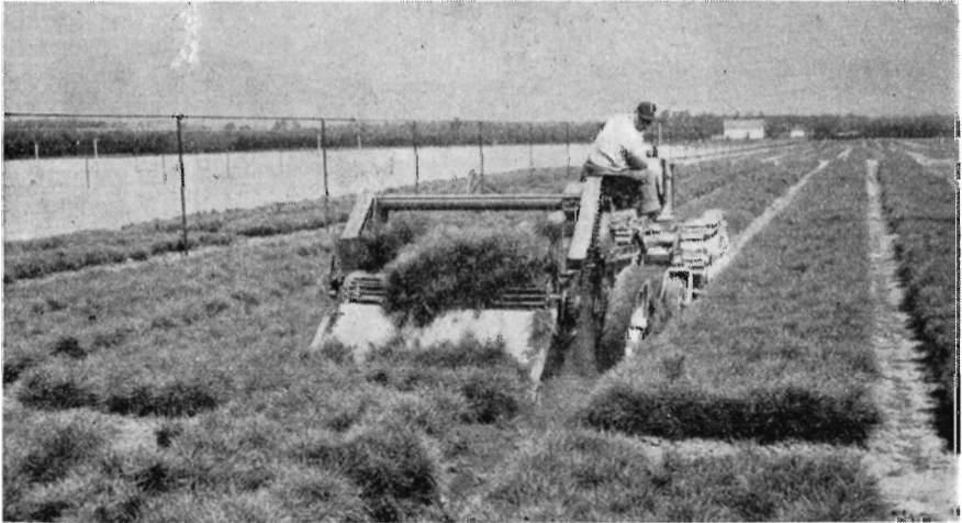
Traktortrukket planteløftemaskine i funktion. Bemærk planterne, der ligger oven på jorden bag maskinen, efter at de er blevet gennemrystet grundigt.
