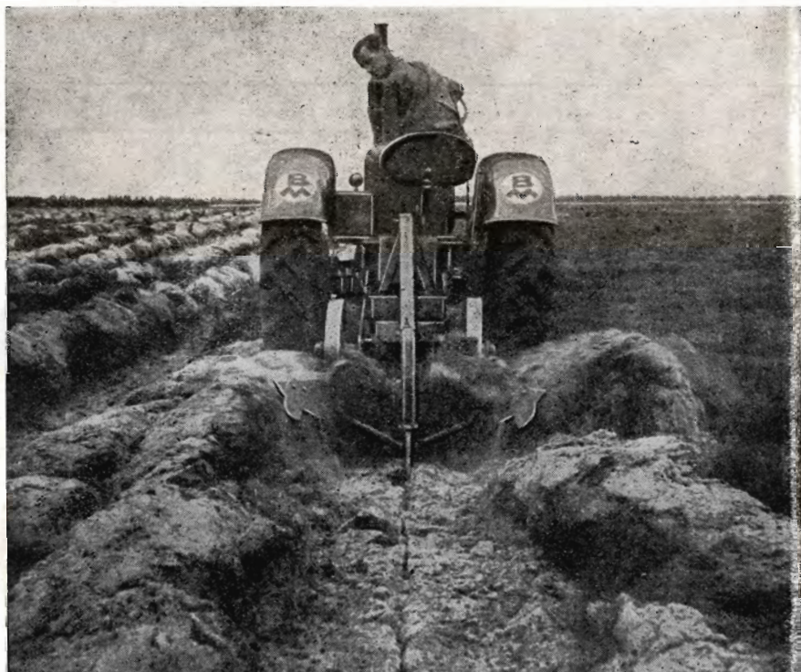
Munktell's-Traktoren med indbygget Plov og Grubber klarer Pløjning af Hede med kun Een-Mands-Betjening
