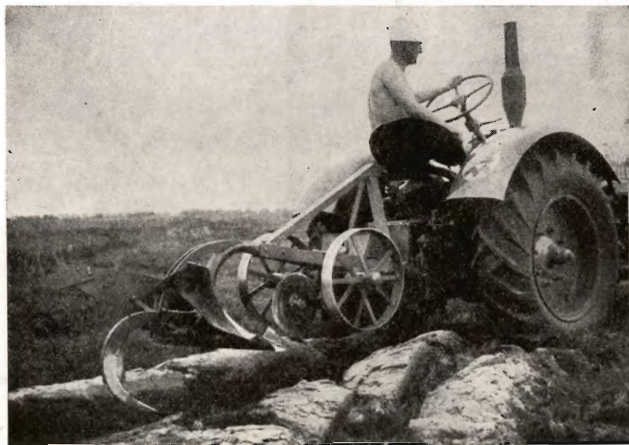
Plov og »Grubber« er løftet op over Jorden under en Vending.
