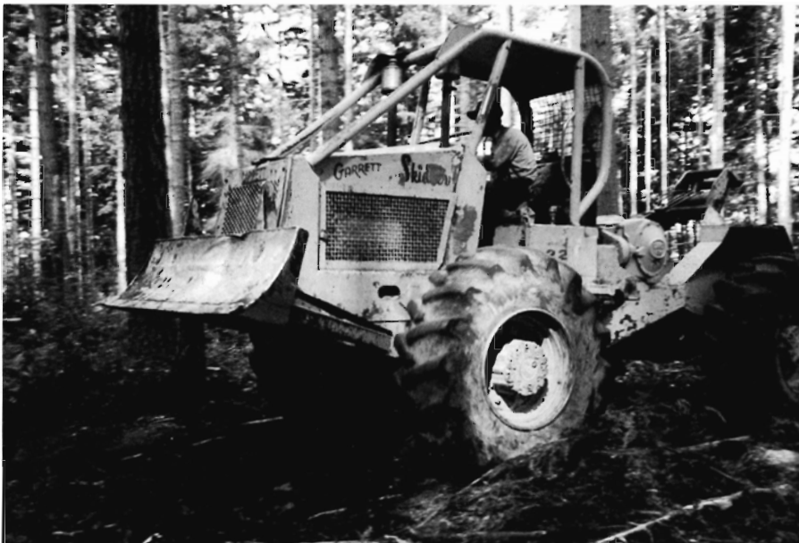
Foto 4. Udkørselstraktor i ung douglasgranbevoksning. Jordstrukturen bliver ofte ødelagt p.g.a. det meget tunge maskinel.
