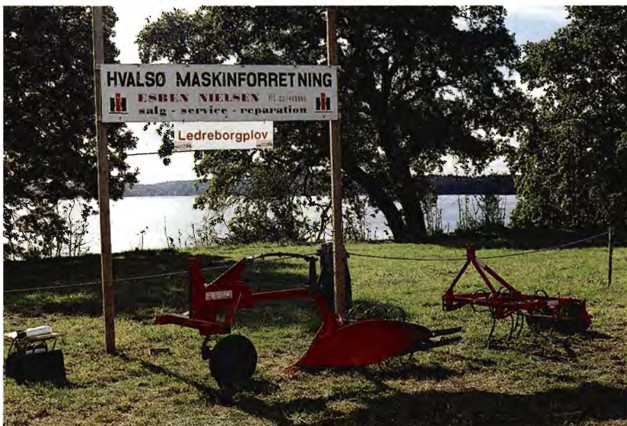
Foto 1. Ledreborgplov og dækharvesystem til bøgeselvfornyelser.
