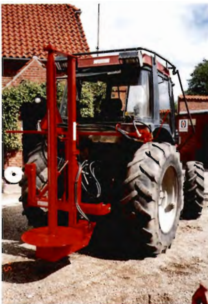
Foto 4. Hegnsruller, som reducerer tidsforbruget ved sætning af permanente hegn med 80%.
