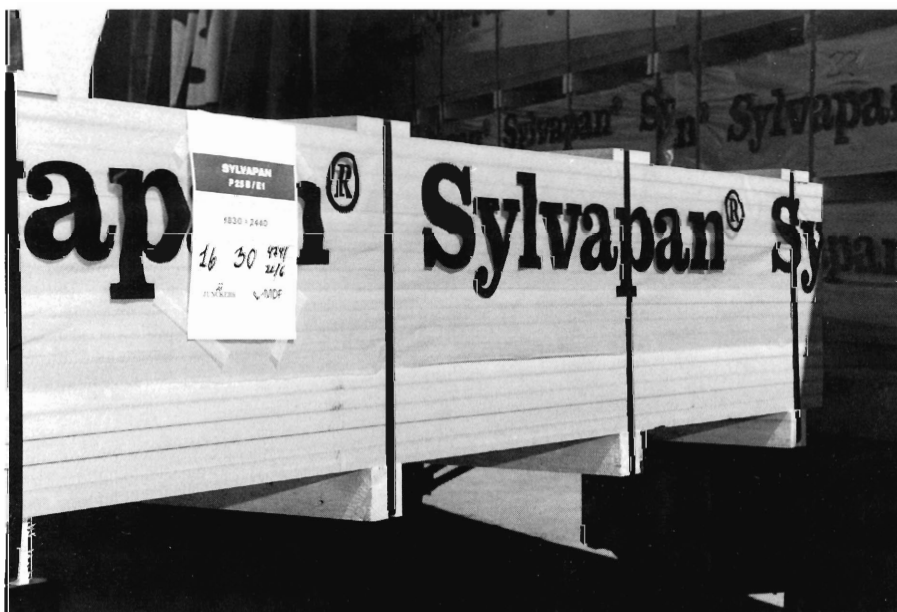
En sending af de nye, tykke MDF plader fra Junckers MDF fabrik i Køge. MDF plader med tykkelser på 25-32 mm er særligt velegnede til fremstilling af bl.a. senge, bordplader, døre og lister pga. den større styrke og stabilitet.
