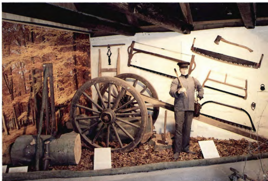
Foto 1. Gamle skovningsredskaber fra før motorsavens tid - skovvippe, hestetrukket blokvogn, håndsav og økse.
