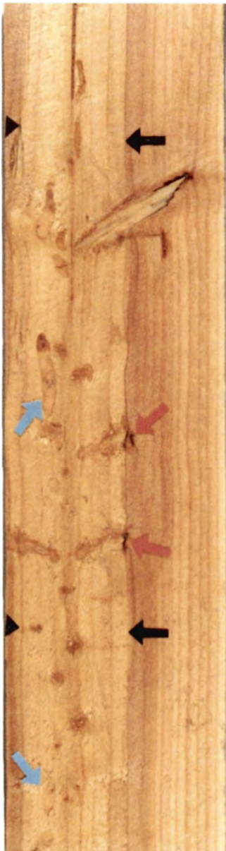
Figur 3. Bræt fra lærkestamme angrebet af træhvepse (larvegange vist med blå pile) og svamp (rådkegle vist med sorte pile). Der ses tydelige spor efter opkvistning (vist med røde pile). Skaden blev først opdaget ved opskæring på savværk. Foto: I.M. Thomsen 14.4.93.
