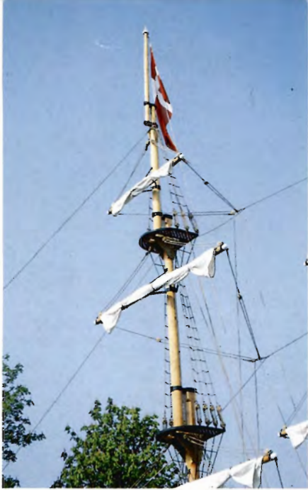
Foto 1. Der er brugt godt en snes douglas-stammer til master og bomme.
