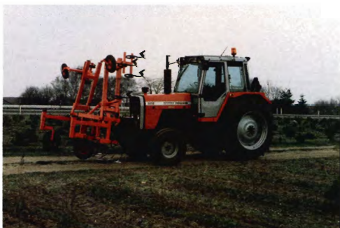
Foto 6. Romlund Renseren manuelt opklappet for landevejstransport.
