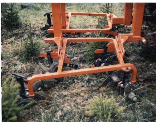
Foto 4. Loft Spaderulleharve - akslerne med spaderuller.
