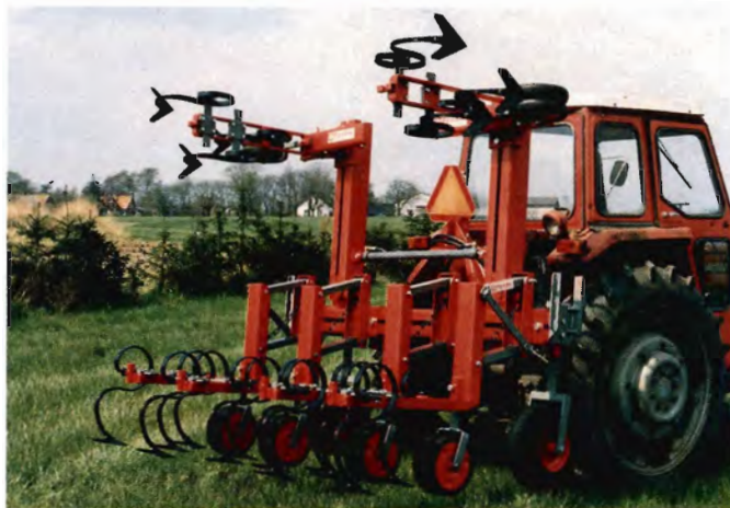
Foto 2. Egedal Radrenser hydraulisk opklappet for landevejstransport.
