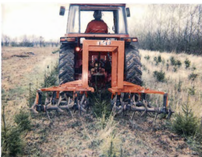
Foto 3. Loft Spaderulleharve renser to rækkellemrum.
