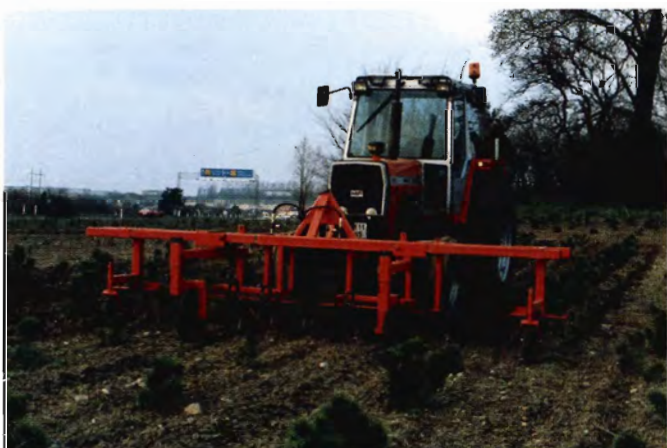
Foto 5. Romlund Renseren kører over en række og renser over tre rækker.
