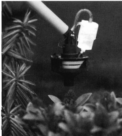
Fig. 1. Scan Bio Jet sprøjten i brug ved haveplanter. Man kan se den hvide spredeskive gennem åbningen som kan reguleres.
