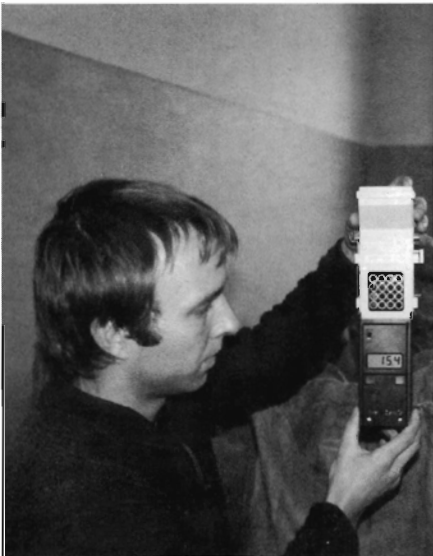
Peter Ochner tager den sidste, vigtige vandindholdstest før plomberingen. 15,4% = sækketørt. Apparatet vi havde med er bærbart, batteridrevet og viste sig at være meget driftsikkert.
