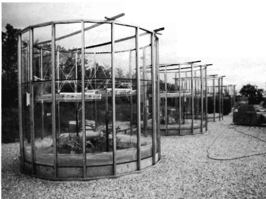
Foto 1. Open-top kamre på Risø. På billedet ses bøgetræerne og over dem lamperne, som leverer UV-B strålingen.
