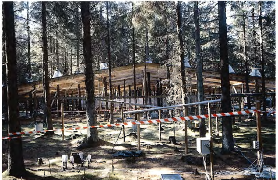
Tagkonstruktionen i en rødgranbevoksning på Klosterheden. Gennem dette tag kan man i forsøget styre hvor meget jorden tilføres i form af fx. vand, døde nåle og forurening.
