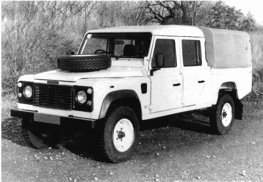
Land Rover "Defender" som 5-personers mandskabsvogn eller pick-up med den nye TDI dieselmotor på 107 hk.
