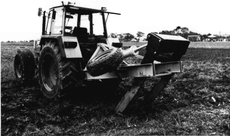
4. HWS Meliorator som løsner komprimeret jord ned til 50 cm dybde.
