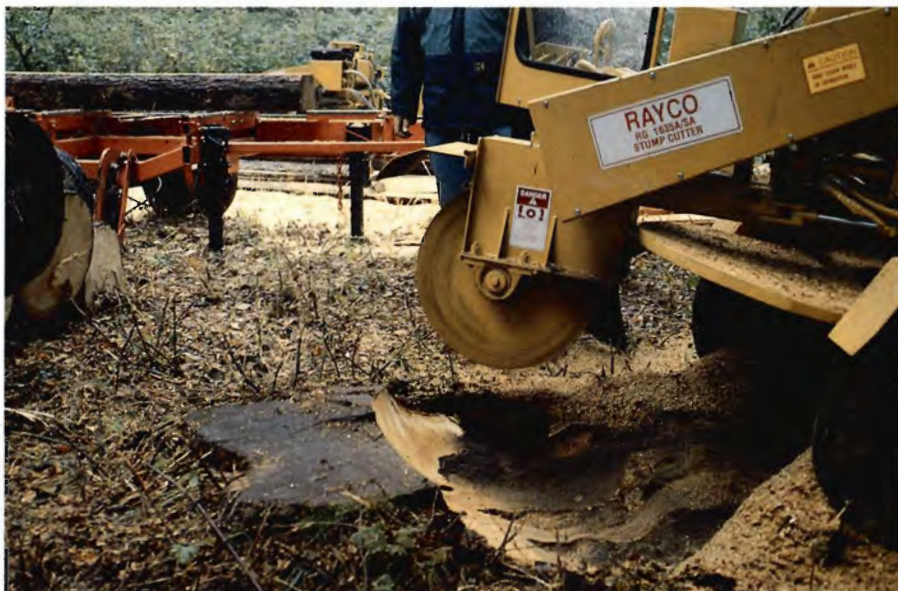
2. Et stød fjernes på 10-15 minutter med en stødfraeser.
