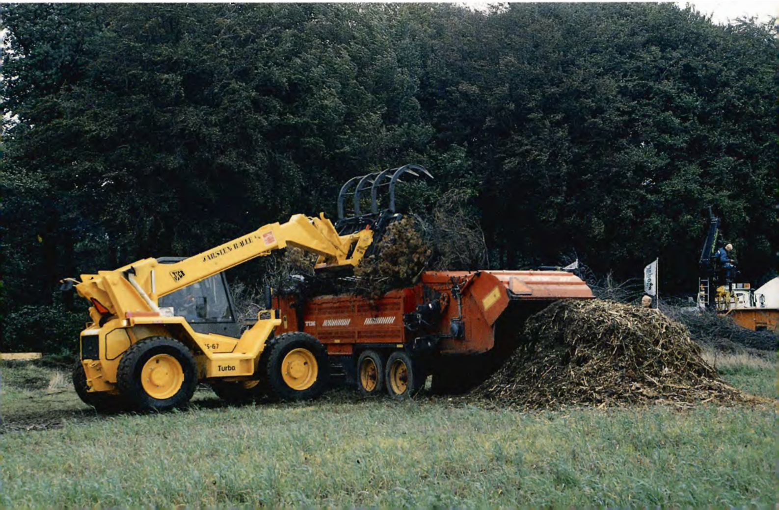
1. TIM sønderdelingsmaskine som på et minut neddeler en stor grabfuld beskæringsaffald til stykker på 5-15 cm længde.
