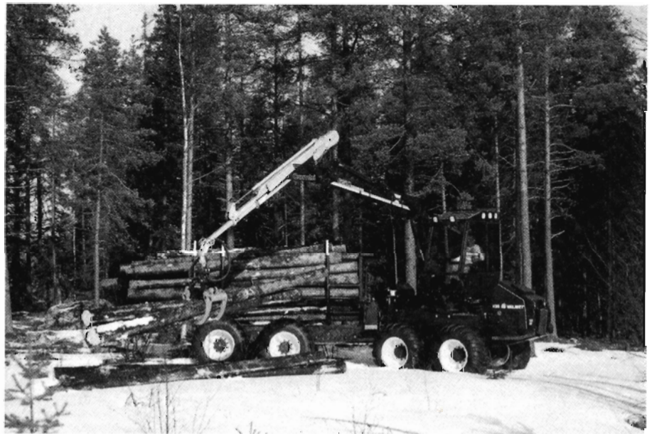
VALMET 838c er et eksempel på en kombineret skovningsmaskine og udkørsels-traktor. I stedet for tungen, som ses på billedet kan monteres et skovningsaggregat. Bemærk det vendbare styrehjul.
