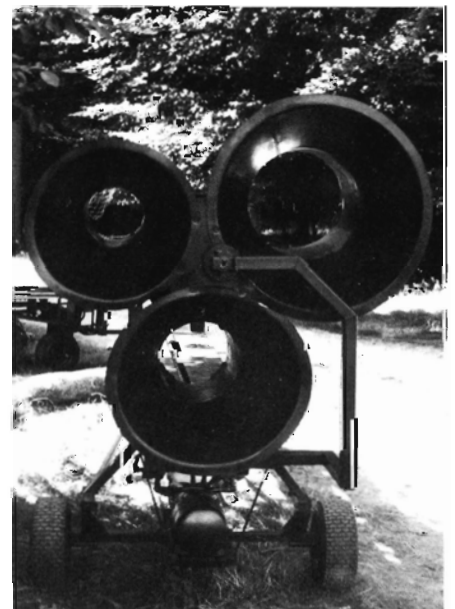
Foto 2. Der var hele 10 fabrikanter af netmaskiner. Net-Let maskinen er forsynet med tre tragte, således at alle størrelser af træer kan pakkes optimalt.
