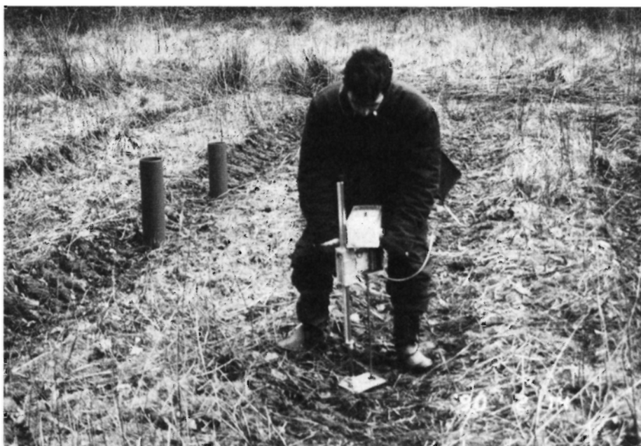
Figur 3. Måling af jordkomprimering (SI foto).
