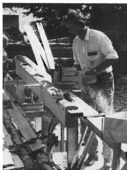
Figur 9. I dag behøver man ikke at lave savgrav – en motorsav på en special bæk er nok. (Firma Interforst).
