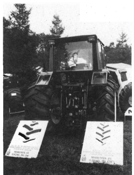
Figur 10. På blødbund er marktrykket betydeligt lavere med de brede dæk end standarddæk – 0,53, hhv. 0,89 kg/cm 2 . (Firma Th. Jensen).
