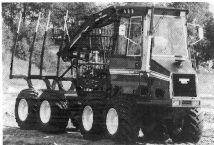
GREMO 704-T udkørselsmaskine. Samme maskine leveres også som skovmaskine med fælde-udstyr.
