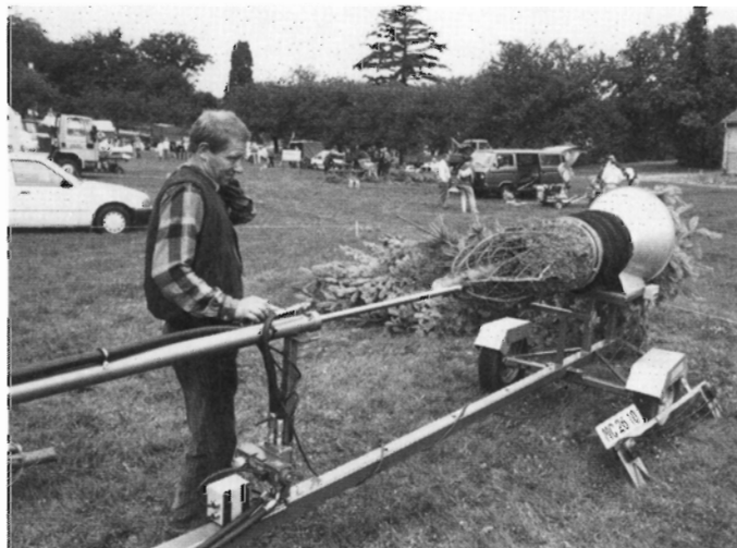
Figur 5. Netmaskine med hydraulisk drevet stempel. (Ørting).
