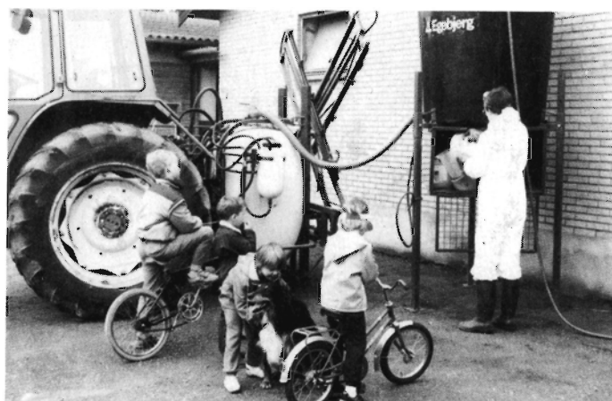
Figur 1. Fyldetanken med kemikalierummet ophængt nedeunder.
