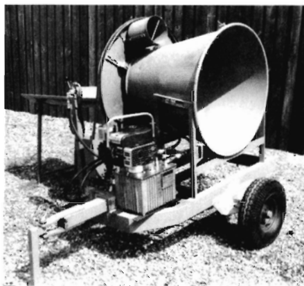
LYN-PAK juletræssnøremaskine type 1 T monteret md hydraulisk pumpestation som kraftkilde.
