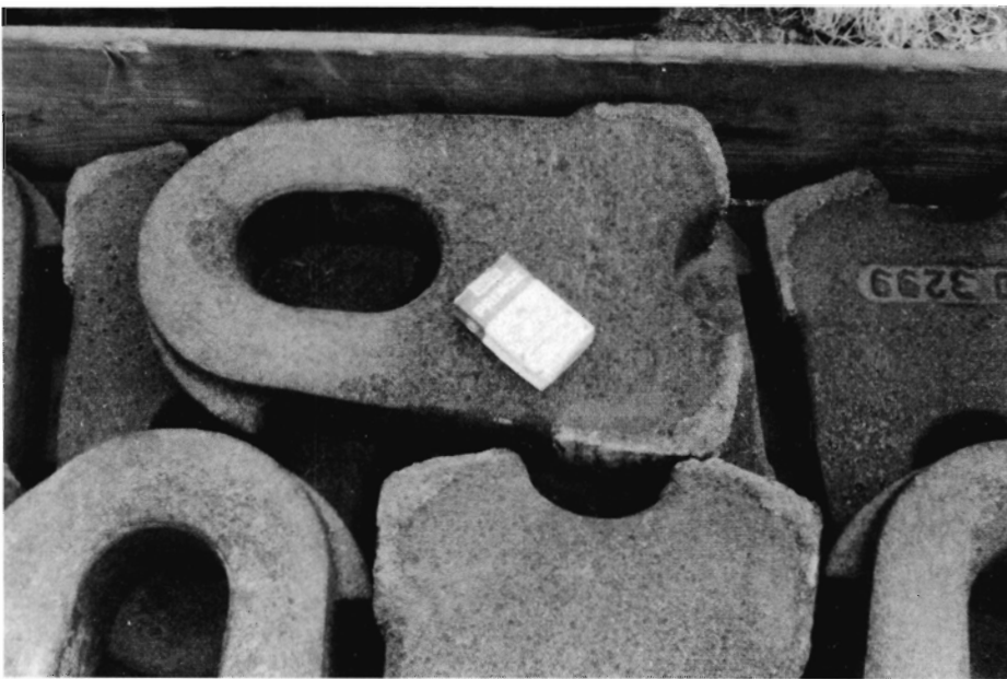
Fig. 4. Slagler til hammermøllen på Gårdstadsverket. Hver slagle vejer mellem 50 og 55 kg.
