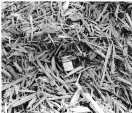
Fig. 7. Stødtræ sønderdelt af hammermøllen.
