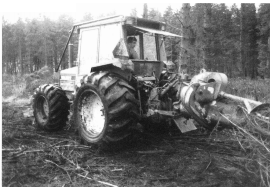
Figur 5. Udslæbningstraktor med superbrede lavprofil dæk. Foto: SH.
