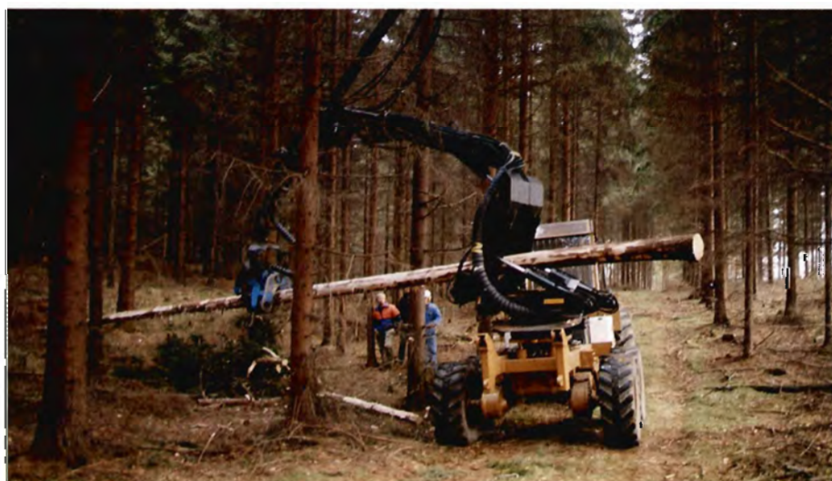
Figur 5. Skov- og Naturstyrelsen viser en prototype på en trævender, som både kan aflægge uafkortet tømmer og afkortede effekter. – Maskinen er udviklet i samarbejde med Silvatec Skovmaskiner.
