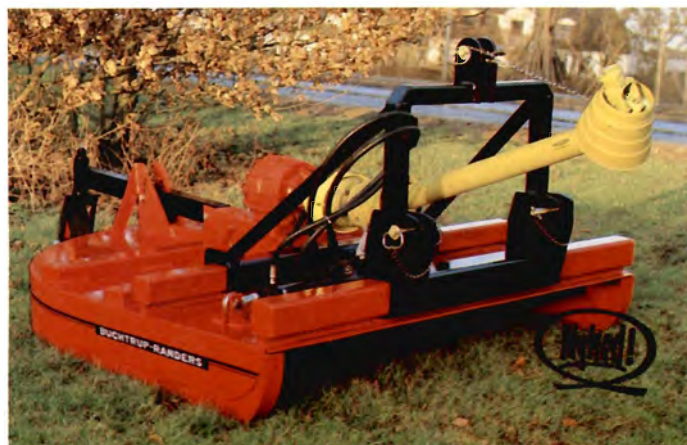
Figur 4. Forbedret Buchtrup knuser.
