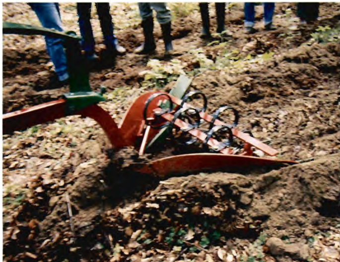
Figur 1. Ledreborgploven laver et fint såbed for bøgeolden.
