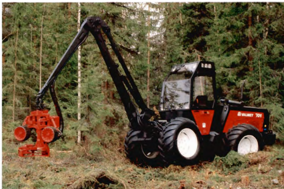
Figur 3. Valmet 701 med Grangärde processoraggregat beregnet til første- og andengangstyndinger.
