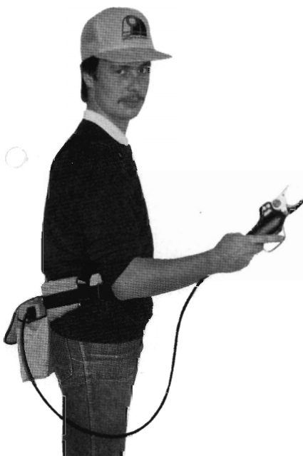
Figur 5. Ny elektrisk saks med proportionalstyring af knivene.
