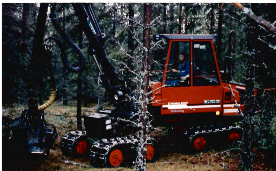
Figur 4. Nokka Joker med Nokka 51 processoraggregat med både længde- og diametermåling.
