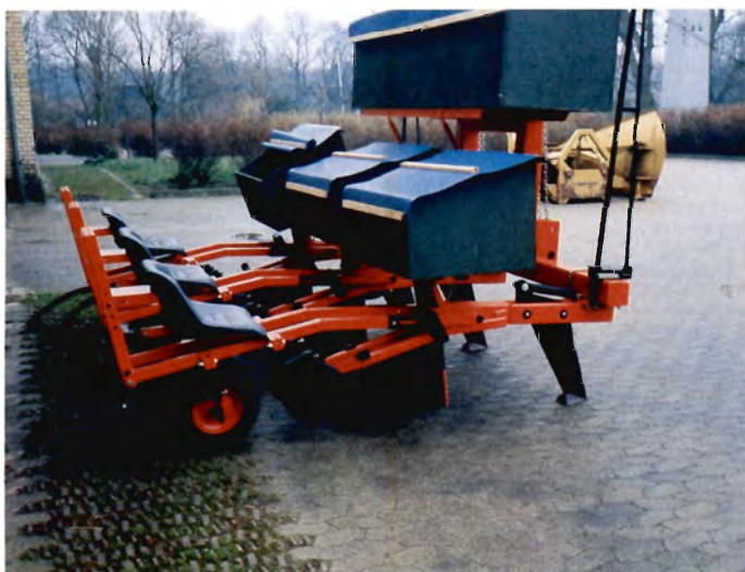
Figur 3. Loft plantemaskine sætter planterne i samme dybde.
