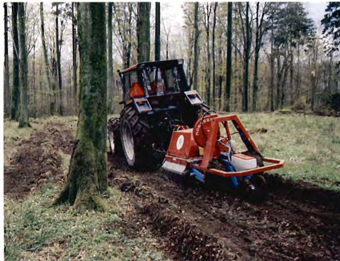
Figur 2. Oldensåmaskine. Prototype udviklet af Skov- og Naturstyrelsen.
