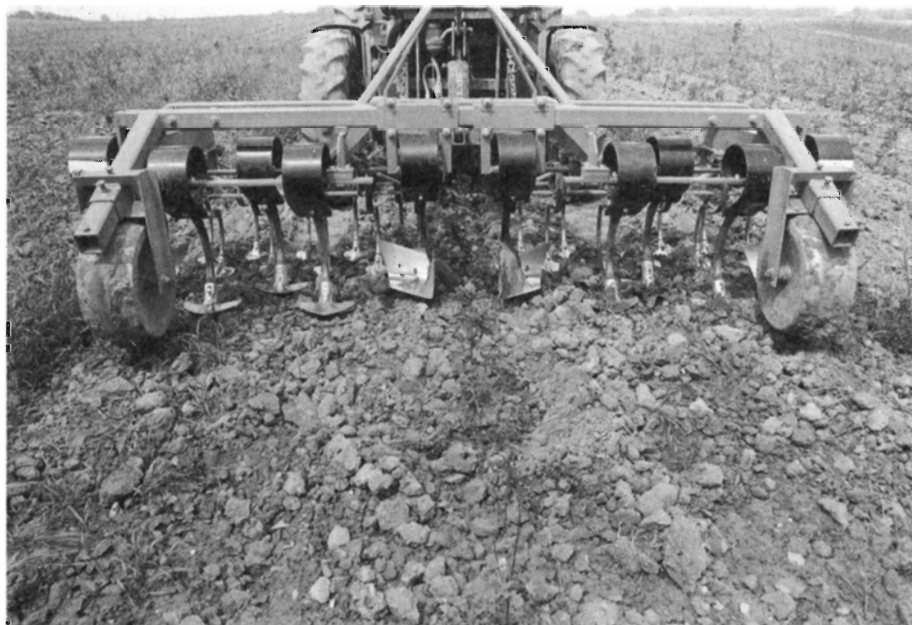
Figur 2. Traktorføreren har et bedre overblik over en frontmonteret rensemaskine, og kan derfor rense helt tæt ind til planterne. Dertil kommer, at det ikke er nær så hårdt for ryggen, som ved en bagmonteret maskine. Planterækken ses i midten. (Foto: Claus Bonnerup/Fokus).
