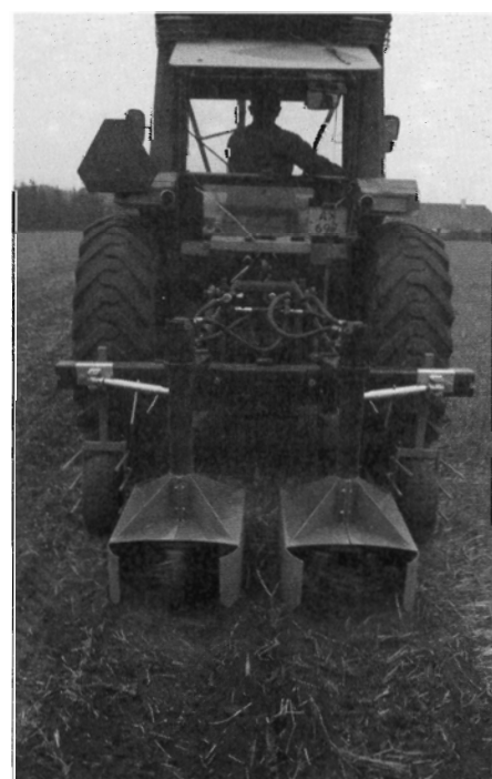
Figur 1 og 2. Ved VM i skovhugning vises flere nye skovmaskiner, bl.a. Hytek oldenopsamler (neden under) og Egedal rotorrensere (th.) som er speciel ved at ukrudtet trækkes op og ikke sønderdeles.
