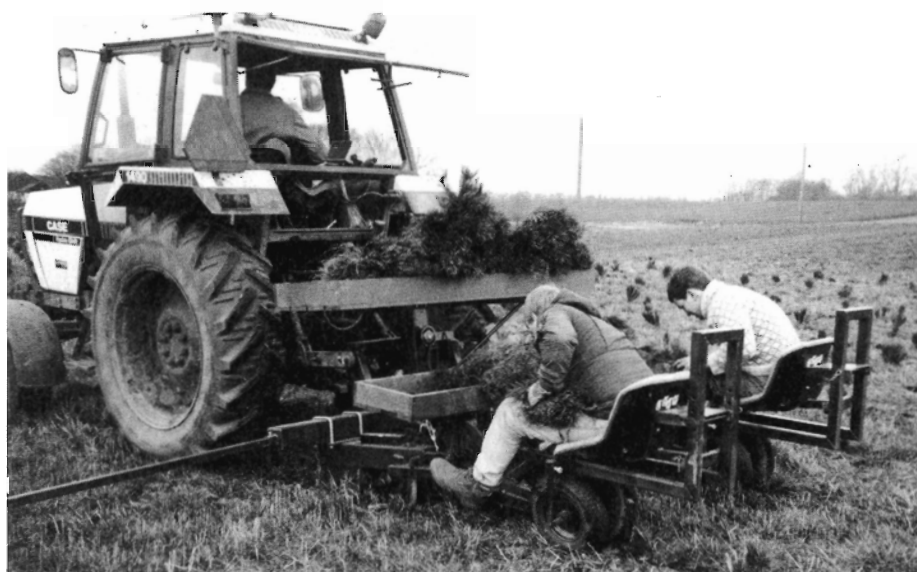
Figur 3 og 4. Ved Skov- og Naturstyrelsens udstilling vises Loft plantemaskine (t.v.) og den velkendte Valmet-Rollo skovtraktor (th.).
