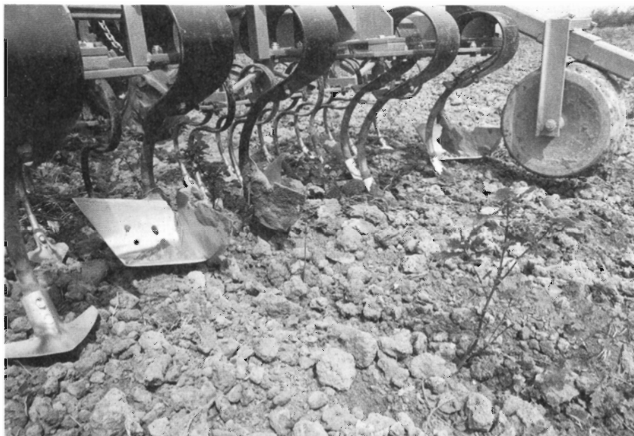
Figur 1. Alle tænderne er boltet fast, så de hurtigt kan skiftes ud, fortæller Henning Hansen, der selv har tegnet og bygget rensemaskinen. (Foto: Claus Bonnerup/Fokus).
